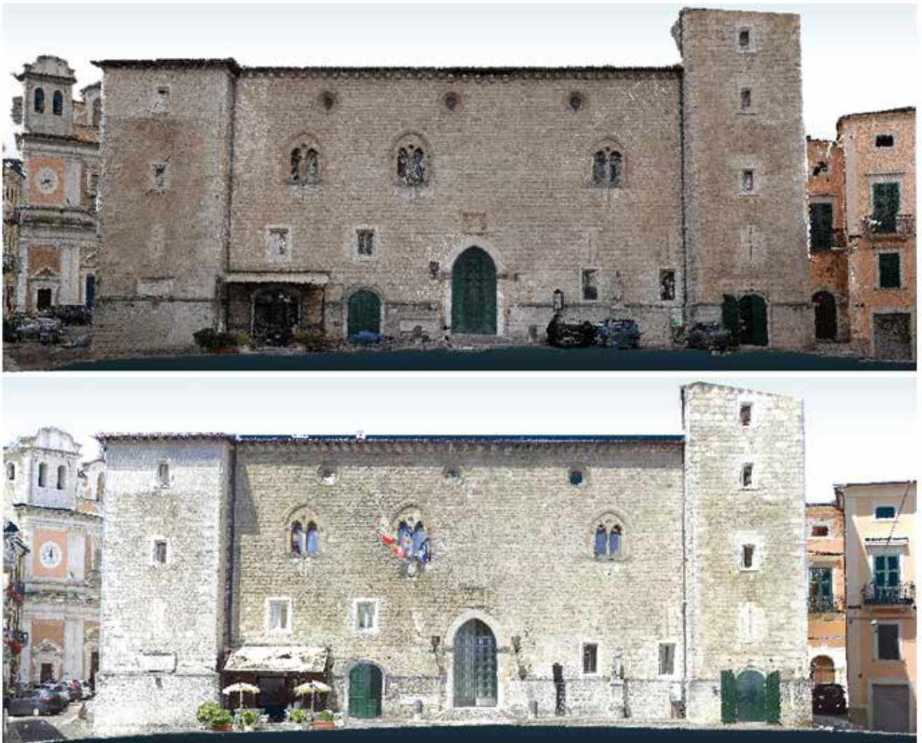
Confronto delle nuvole di punti del fronte del Palazzo Ducale Cantelmo (affacciato su piazza Veroli): in alto da fotogrammetria digitale, in basso da laser scanner
