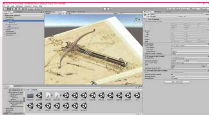
Fig. 3 - Inserimento del modello della balestra nel software Unity, utilizzato per lo sviluppo dell'app di realtà aumentata. Il disegno originale è preso come riferimento affinché l'oggetto tridimensionale si generi proprio a partire dai corrispondenti tratti rappresentati sul foglio da Leonardo.
